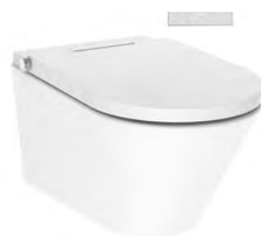
AXENT.ONE PLUS DUSCH-WC aus Keramik, Sitz und Deckel mit Absenkautomatik, spülrandlos, Breite: 370 mm, Höhe: 397 mm, Tiefe: 593 mm
