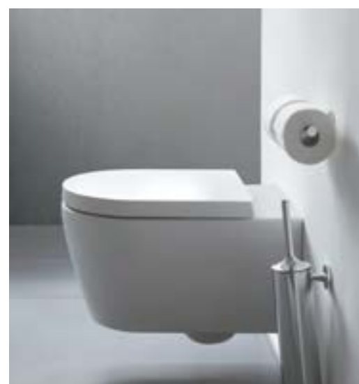
ME BY STARCK WAND-WC aus Sanitärkeramik, Sitz und Deckel mit Absenkautomatik, auch als Komfort-Version erhältlich: WC mit Dusch-WC-Sitz-SensoWash®-Slim inklusive Fernbedienung für alle Grundfunktionen, Breite: 370 mm, Höhe: 400 mm, Tiefe: 600 mm
