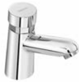
WASCHTISCHARMATUR SELBSTSCHLUSS verchromt, individuelle Laufzeiteinstellung, Ausladung: 101 mm
