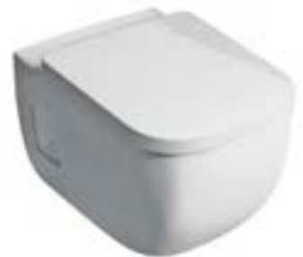
WAND-WC aus Sanitärkeramik, 50 mm erhöht, mit PflegePLUS, ohne Spülrand, inkl. WC-Sitz, Breite: 360 mm, Tiefe: 540 mm
