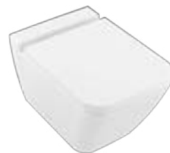
WAND-TIEFSPÜL-WC aus Sanitärkeramik, spülrandlos, Breite: 375 mm, Tiefe: 560 mm
