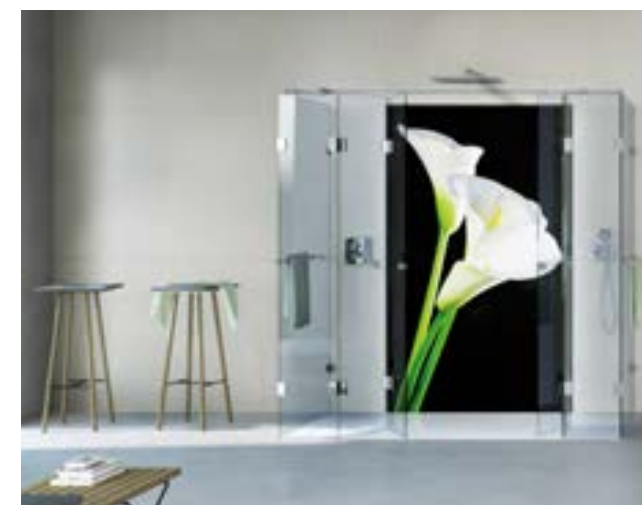
DUSCHKABINE: 6 bzw. 8 mm starkes Einscheiben-Sicherheitsglas, Breite: 1.200 mm, Höhe: 2.000 mm, Türglas: max. 1.000 mm LEUCHTWAND: 6 mm starkes Einscheiben-Sicherheitsglas, Gesamtstärke inkl. Aluminiumpaneel: 21,5 mm, Breite: bis max. 1.600 mm, Höhe: bis max. 2.600 mm
